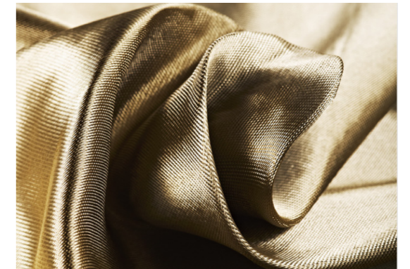
石金玄武岩生产的玄武岩纤维布，在抵御 6.5Km/s 空间碎片撞击上，可使抵御能力提高 3 倍以上，被应用于中国航天空间站建设
